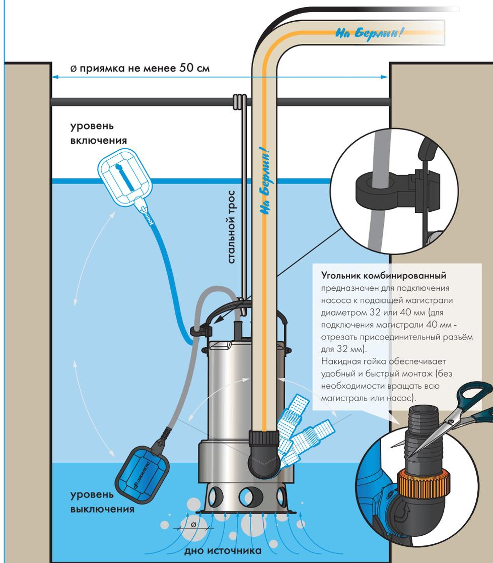
Рисунок 3 (на примере изображен насос погружной «ФЕКАЛЬНИК» 150/7Н).
