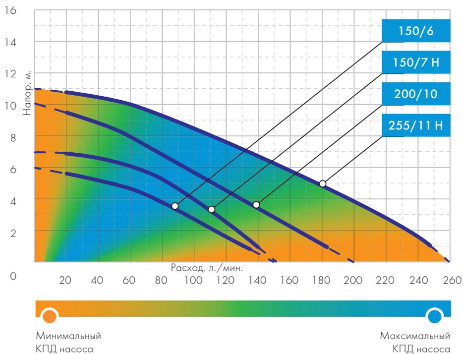
\* Заявленные характеристики насосов были получены при испытании с холодной чистой водой без газа и абразивных примесей, а также напорной магистралью диаметром 40 мм и напряжением 220 вольт.
