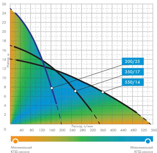
\* Заявленные характеристики насосов были получены при испытании с холодной чистой водой без газа и абразивных примесей, а также напорной магистралью диаметром 40 мм (65 мм для модели 550/14) и напряжением 220 вольт.
