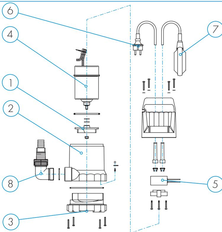
Рисунок 2 (на примере изображен насос погружной «ДРЕНАЖНИК» 110/6).
